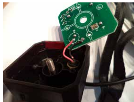
Foto 11: De waterdichte batterijdoos met zekering
