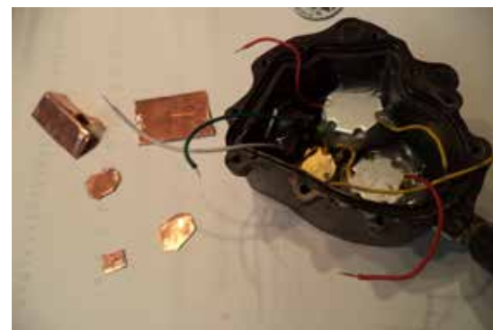
Foto 5: We maken de koperstrips klaar die als warmtegeleiders zullen dienen.
