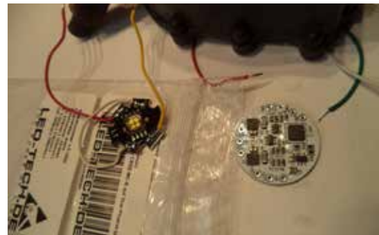
Foto 2: De quadruple-led en de dualflex regulator
