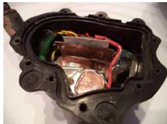
Foto 10: De dualflex gekoeld via de warmtegeleidende koperstrip
