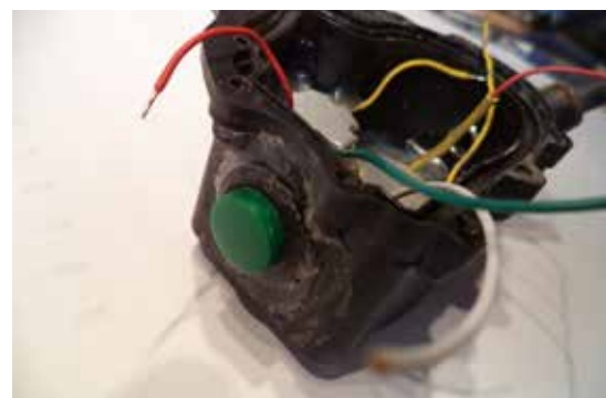
Foto 4: Montage van de waterdichte schakelaar
