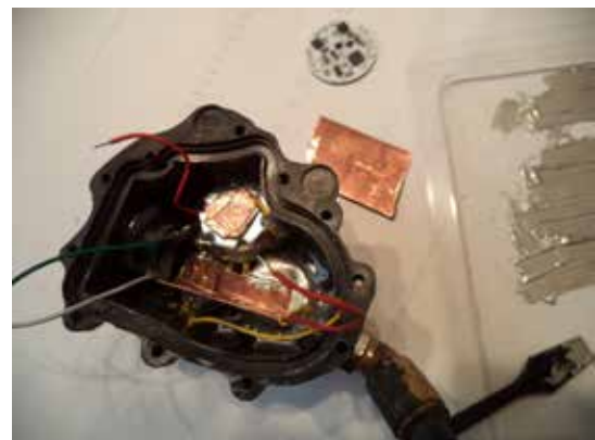
Foto 7: De warmtegeleidende strips worden op de leds gekleefd.
