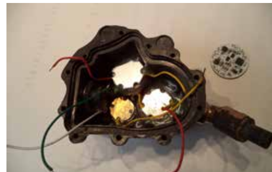
Foto 3: De leds zijn netjes in de lamp gekleefd.
